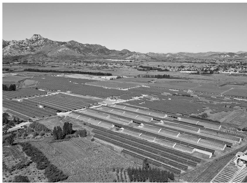
近年来,秦皇岛市抚宁区依托科技引领高标准农田建设,将光伏发电和高效农业有机结合,在抚宁区坟坨村建设“农光互补”光伏发电项目。该项目占地近800亩,于2019年底实现全部并网,利用光伏阵列的间隙建设高架智能温室和普通暖棚,发展设施栽培、旅游休闲观光、生态养殖等项目,在生产清洁能源的同时,提高土地利用率。农民通过收取土地租金、土地返租耕种、入园打工等方式获得收益,亩均收入由原来的200元提高至万余元。
