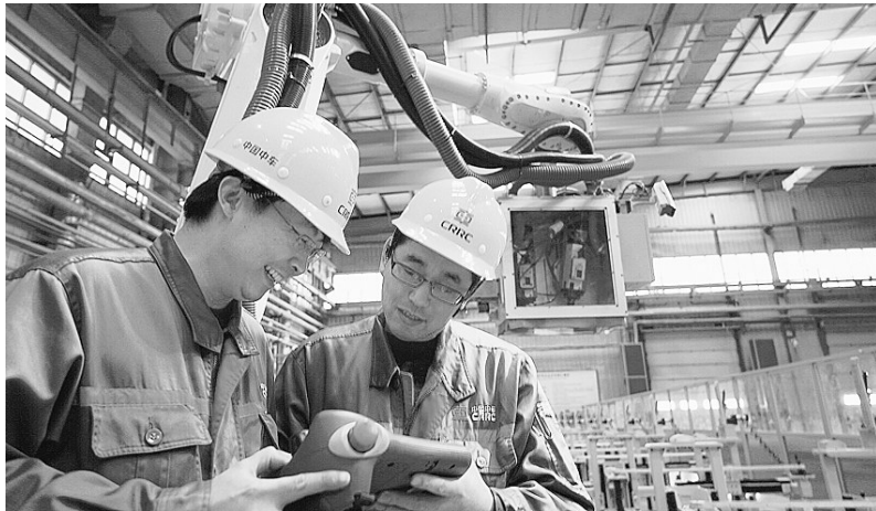
3月10日,中车唐山机车车辆有限公司铝合金厂高级技师张雪松(右),正在和同事一起调试动车组铝合金车体侧墙焊缝自动打磨机器人。 记者 刘禹彤/摄
