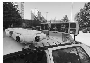
本报保定电(记者田媛媛) 10月12日起,保定公安交警的 "车载违法抓拍设备"正式开始 投入使用,上路抓拍交通违法
